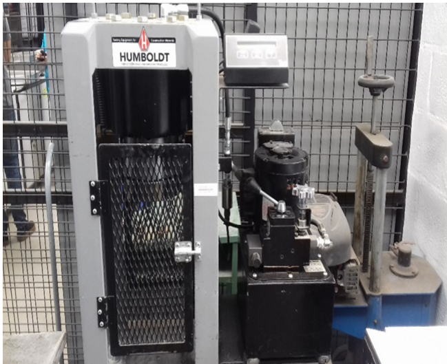
Figura 2. Equipo para ensayos de resistencia a la compresión Humboldt.
