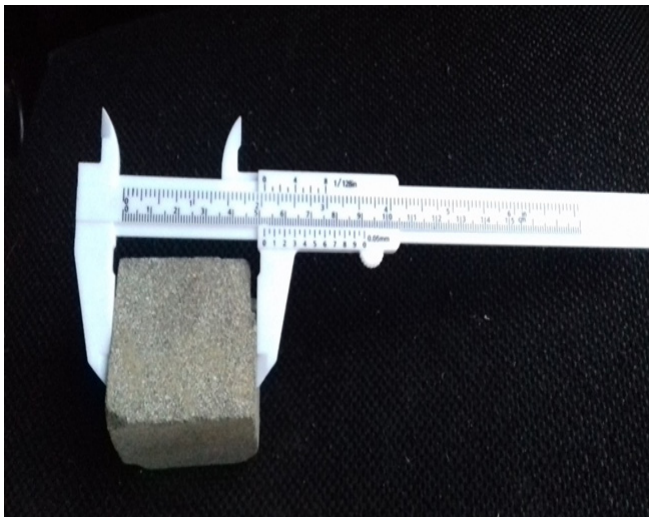
Figura 3. Probeta sometida a medición inicial con calibrador común.
