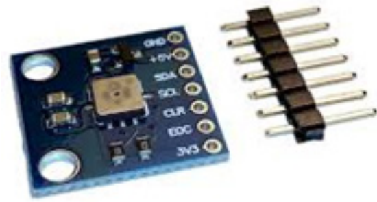
Figura 6. Sensor de presión BMP085
