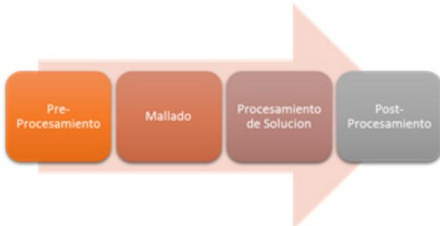
**Fig.10 Procedimiento clásico para simulación mediante MEF**
