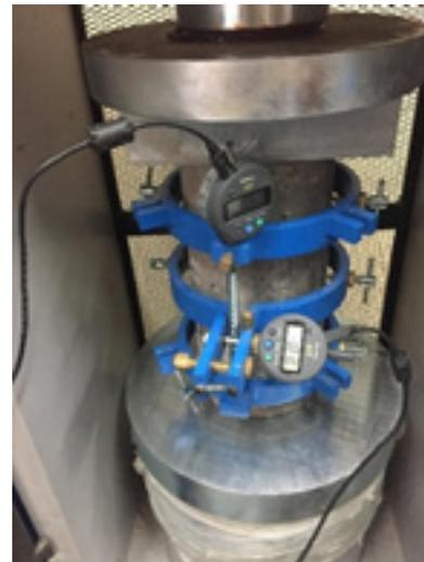
Fig. 6 Montaje de probeta de hormigón.
