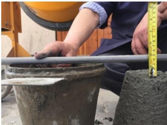
**Fig.3 Prueba del cono Abrahms.**
