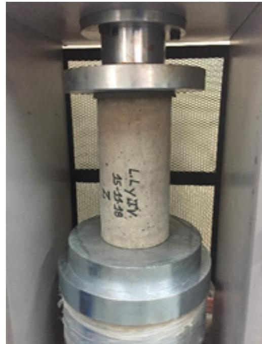
**Fig.4 Probeta de Hormigón en montaje de prensa.**
