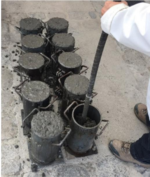
**Fig.2 Proceso de compactado de la mezcla de hormigón en el encofrado metálico.**
