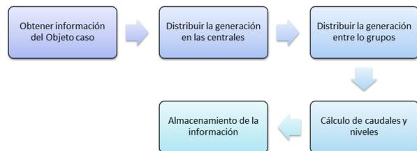
Figura 14: Proceso realizado para ejecutar una simulación
