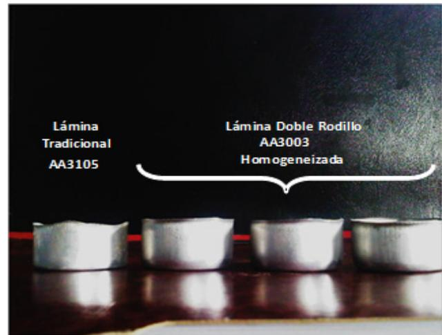
**Figura 2. Fotografía de las copas del ensayo Swift de embutición profunda de las aleaciones comerciales de aluminio de Alcasa, la tradicional AA3105 y AA3003 de esta investigación**
