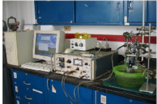
Figura 5: Montaje de los ensayos electroquímicos. Se muestra la celda inmersa en el baño termostatzado, el potencióstato, el convertidor analógico digital, la base de tiempo y la computadora de escritorio.
