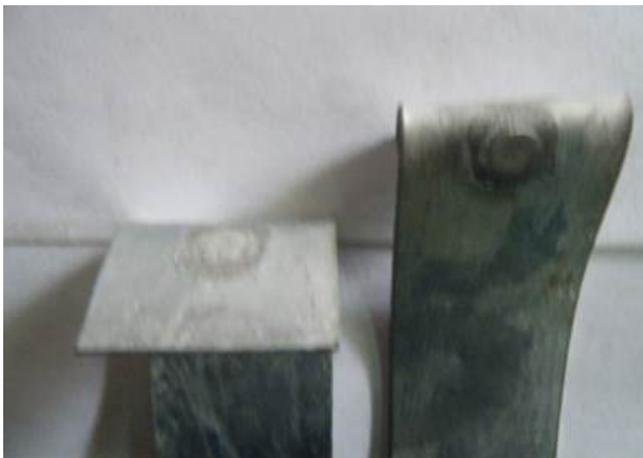
Figura 7: Probeta PG35 después de realizar el ensayo de desabotonado.
