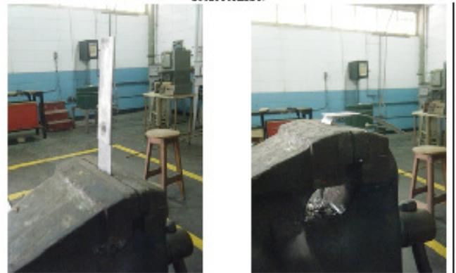
Figura 3: Sujeción de la Probeta en la prensa para el ensayo de desabotonado
