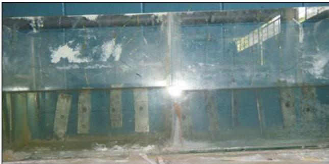
Figura 4: Ensayo gravimétrico para las probetas con recubrimiento G35, G50 y G100 sumergidas en NaCl al 3.5% (derecha) y NaCl al 3.5% acidificado (izquierda).
