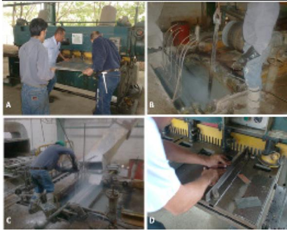
Figura 2: Proceso de galvanizado por inmersión en caliente. A) Corte de lámina de acero en tiras, B) Proceso de fluxado con cloruro de amonio y C) Inmersión en baño de cinc a 450°C y D) Corte de las tiras galvanizadas en las distintas medidas para los ensayos.
