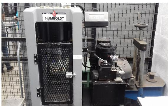
Figura 4: Máquina de compresión Humboldt.
