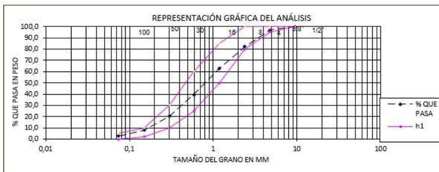
**Fig. 2.** Curva granulométrica del agregado fino.
