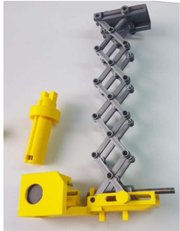
**Fig. 16. Mecanismo de Tijera Implementado**
