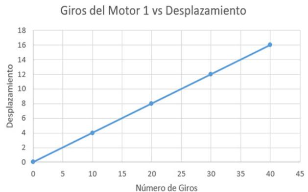
**Fig. 21. Relación entre los Giros del Primer Motor DC y el Desplazamiento.**
