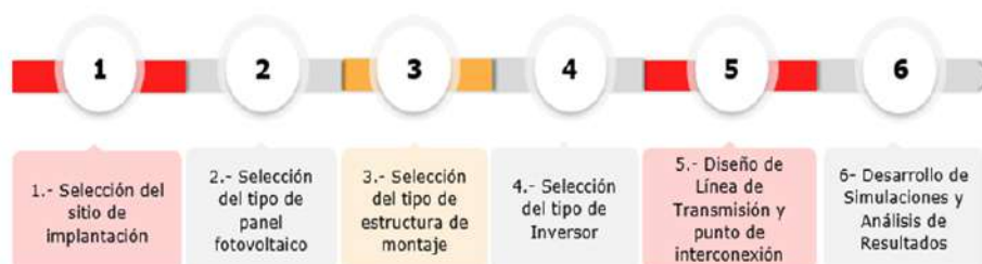
Fig. 2. Esquema general del diseño de la planta fotovoltaica propuesta Fuente: propia.
