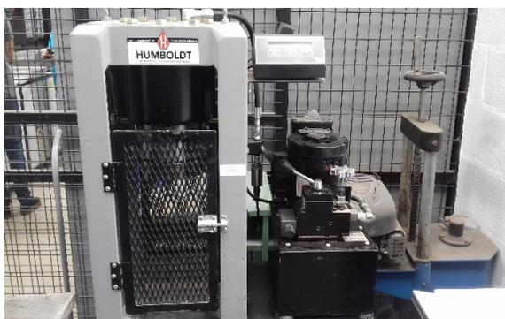
Figura 4: Máquina de compresión Humboldt.
