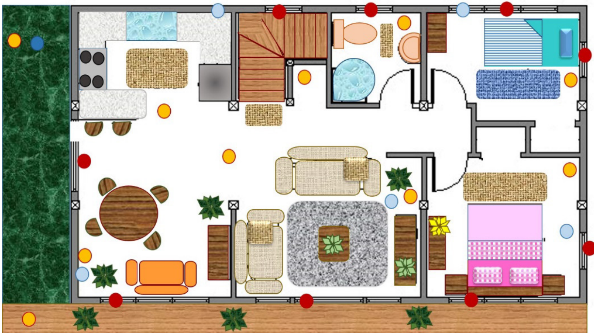
Fig. 1. Casa domótica básica, el círculo azul simboliza un sensor de apertura y cierre de agua para regar el césped, los círculos amarillos son sensores para el control de la iluminación, los círculos rojos son sensores para la protección de puertas y ventanas, y los círculos celeste son para el control de la calefacción.
