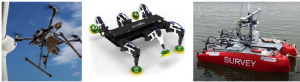
Fig. 3. Drones de inspección en desarrollo y un vehículo de superficie no tripulado (USV) para operaciones de reconocimiento autónomo [13]
